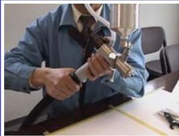
フローアのスイッチを切り、エアホースを塗装ガンから取り外します。
