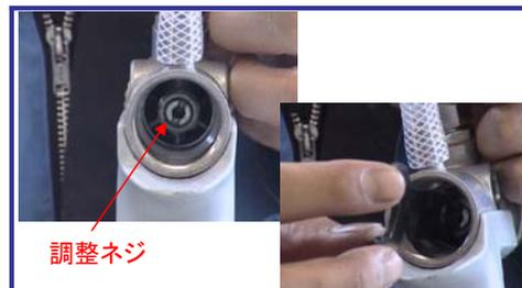
ニードルのパッキンは、ガン後部の樹脂部品を外すと、調整用のネジが見えます。塗料漏れが発生する場合は、このネジを締めこんでください。
