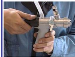
カップを取り外し、引き金を引いた状態で、後部の樹脂(大)を取り外します。これで、ニードル関係が取り出せます。
