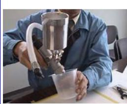
逆流の洗浄が終わりましたら、引き金を引き、塗料経路内の洗浄シンナーを抜いてください。
