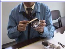
また、パッキンに塗料が付着している時は、付属の洗浄用ブラシで必ず落としてください。
