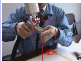
エアホースを接続し、ガン先に指をあてます。この状態で、引き金を引くと塗料経路が逆流します。
