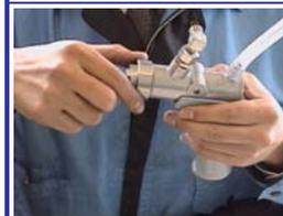
ガン先端のナットを外します。これで、エアキャップが外れ、ノズルがむき出しになります。
